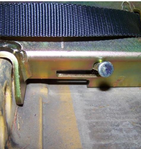
Jale el **Perno de Bloqueo** hacia atrás y arriba hasta 'amartillar' en la ranura vertical. Remueva el Chock.
