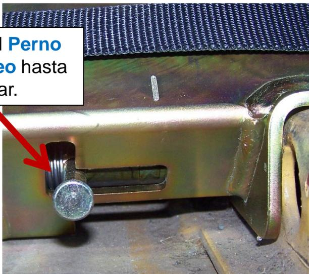
Estará **completamente anclado**, cuando el **Perno de Bloqueo** quede en línea con la Marca de Alineamiento.
